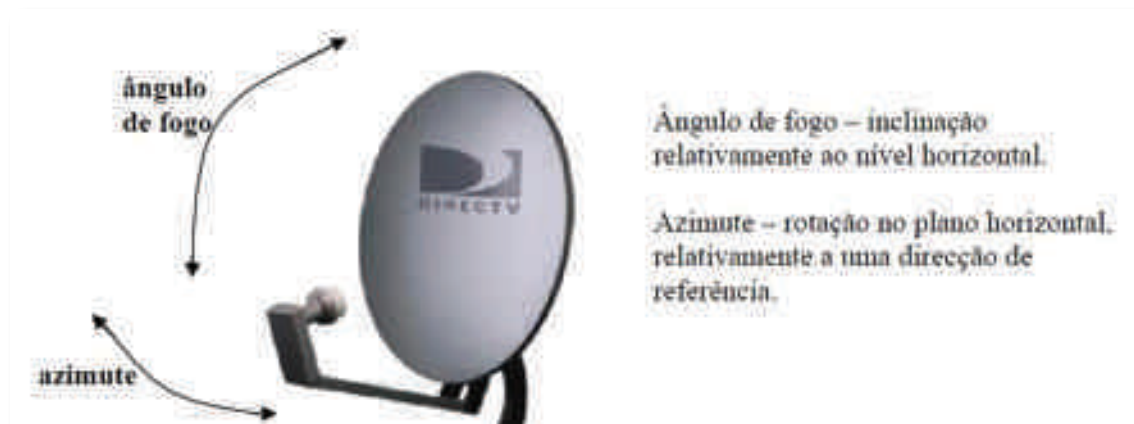
Fig. 6 – Graus de liberdade de uma antena parabólica.
