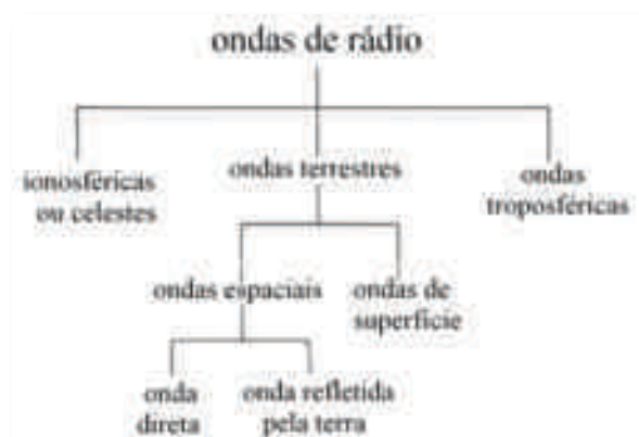
Fig. 48: Modos de propagação das ondas de rádio.
