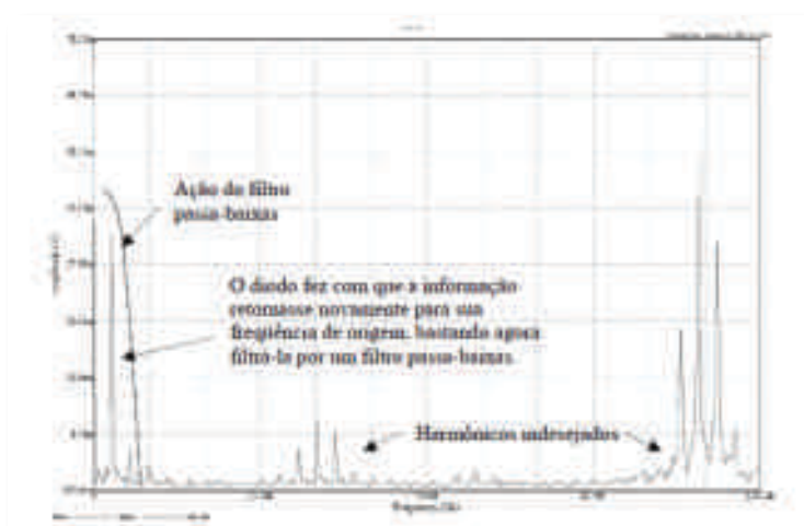
Fig. 23 – Espectro do sinal AM retificado pelo diodo visto no ponto E.
